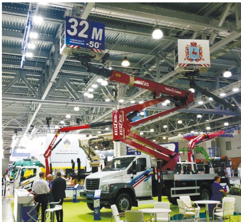
Автоподъёмник «Чайка-Сервис» высотой 32 метра на шасси среднетоннажника «Газон NEXT»
