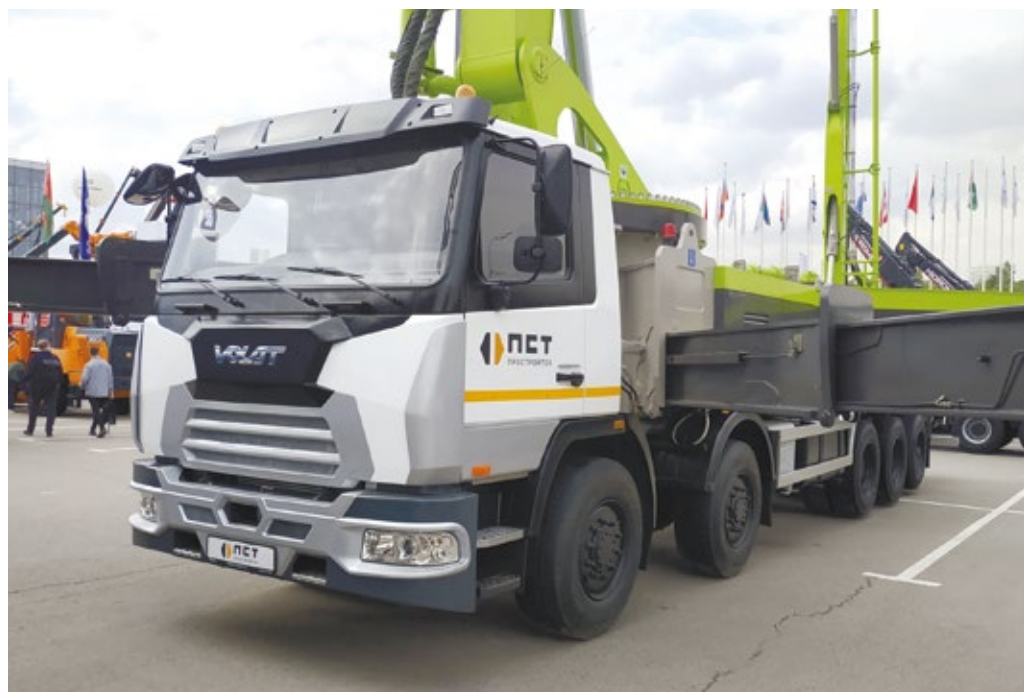
Пятиосный Volat установку 62-метрового бетононасоса Zoomlion
